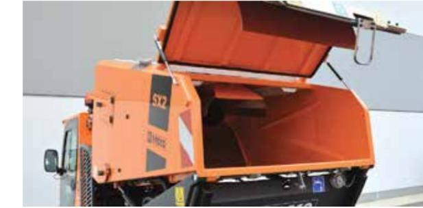
Die Ausführung des Behälters mit einer breiten Öffnung an der Hecktür ermöglicht eine hohe Abfallentleerung in kommunale Container.
