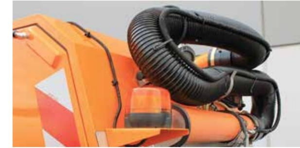
Für die Reinigung der Abfallbehälter, Kanalisation-Öffnungen und Flächen, die MUVO mit seinen vorderen Bürsten nicht erreichen kann, ist der Reiniger mit manuellem Saugschlauch ausgestattet.
